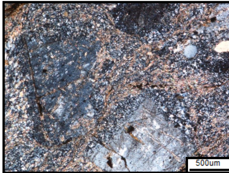
FIGURA 35. En la parte inferior se observa fenocristal de albita con manchas oscuras antiperíticas de feldespato potásico. En la parte superior izquierda se observa fenocristal de ortoclasa con inclusiones períticas de albita. Imagen tomada en nicoles cruzados con objetivo x10.
