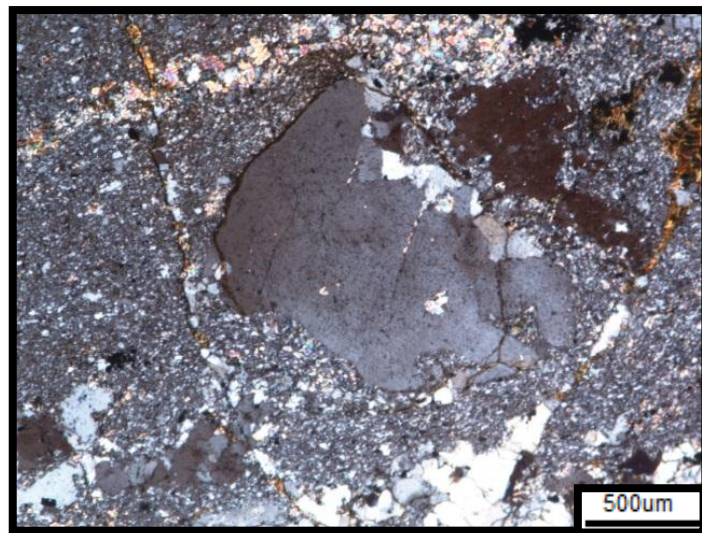
FIGURA 41. Fenocristal de cuarzo con extinción ondulante generada por dislocación intracristalina. Imagen tomada en nicols cruzados con objetivo x10.
