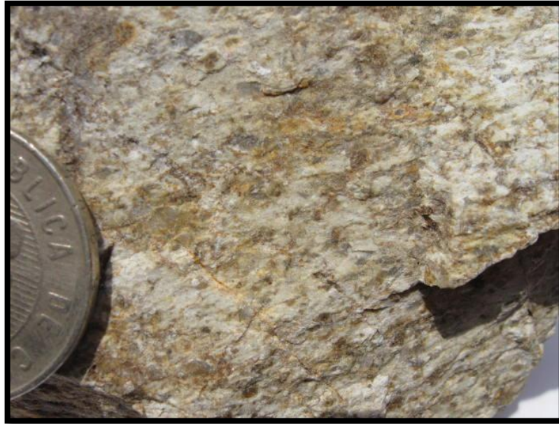
FIGURA 13. Aspecto de las rocas riolíticas con textura microporfírica. Los fenocristales presentan alargamiento, debido a procesos de deformación dúctil (reorientación preferente).
