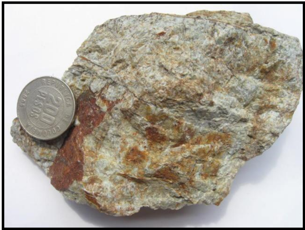
FIGURA 12. Aspecto de las rocas riolíticas con textura microporfirítica con tamaños de fenocristales menores a 3 mm y afectadas por microfracturamiento.
