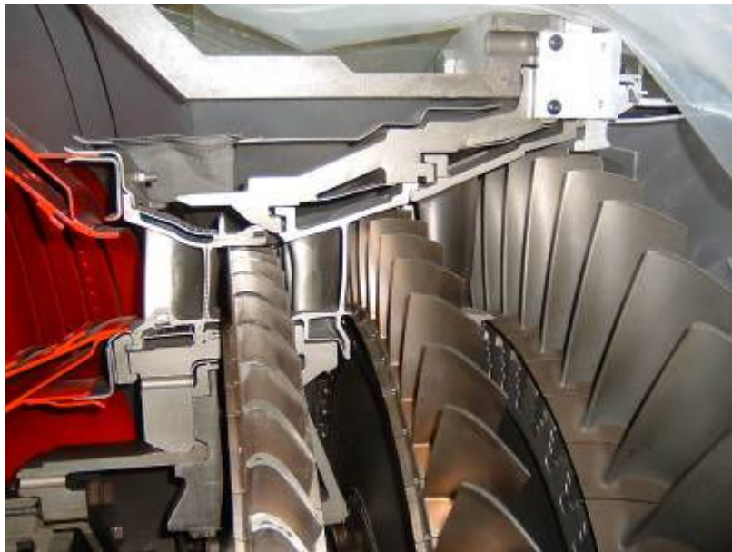
Figura 34. Turbina de potencia
