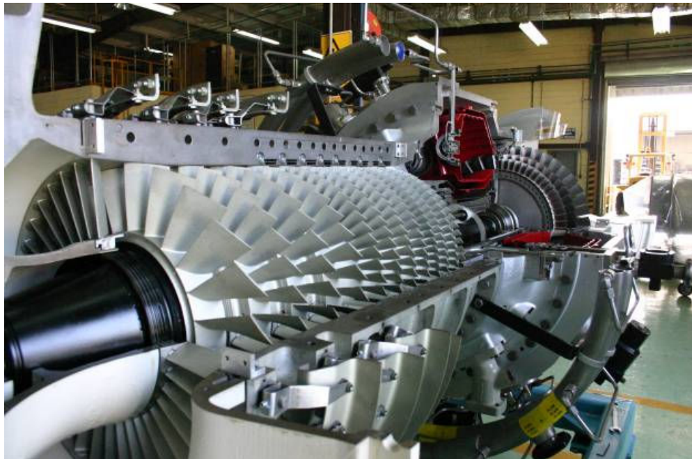
Figura 26. Vista compresor axial
