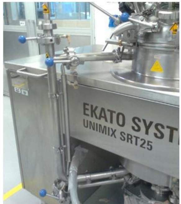
Figura 3. Tubería de recirculación equipos Unimix 50 y Unimix 25 respectivamente
