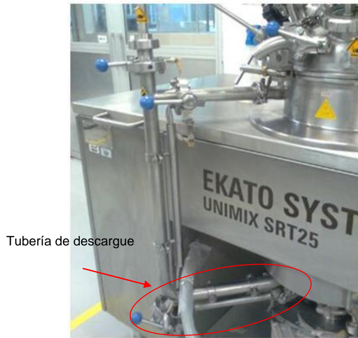
Figura 6. Tubería de descargue y recirculación Unimix 25
