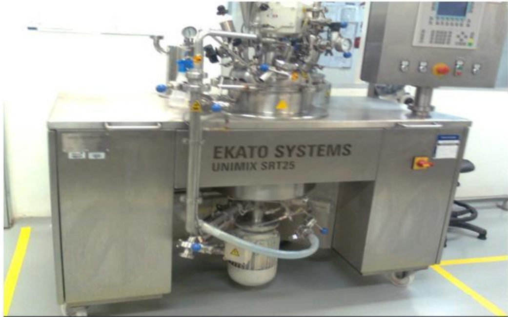
Figura 2. Mezclador Unimix 25. Se puede apreciar la tubería de recirculación empleada en la homogenización externa, la válvula de descargue y la estructura general del equipo.
