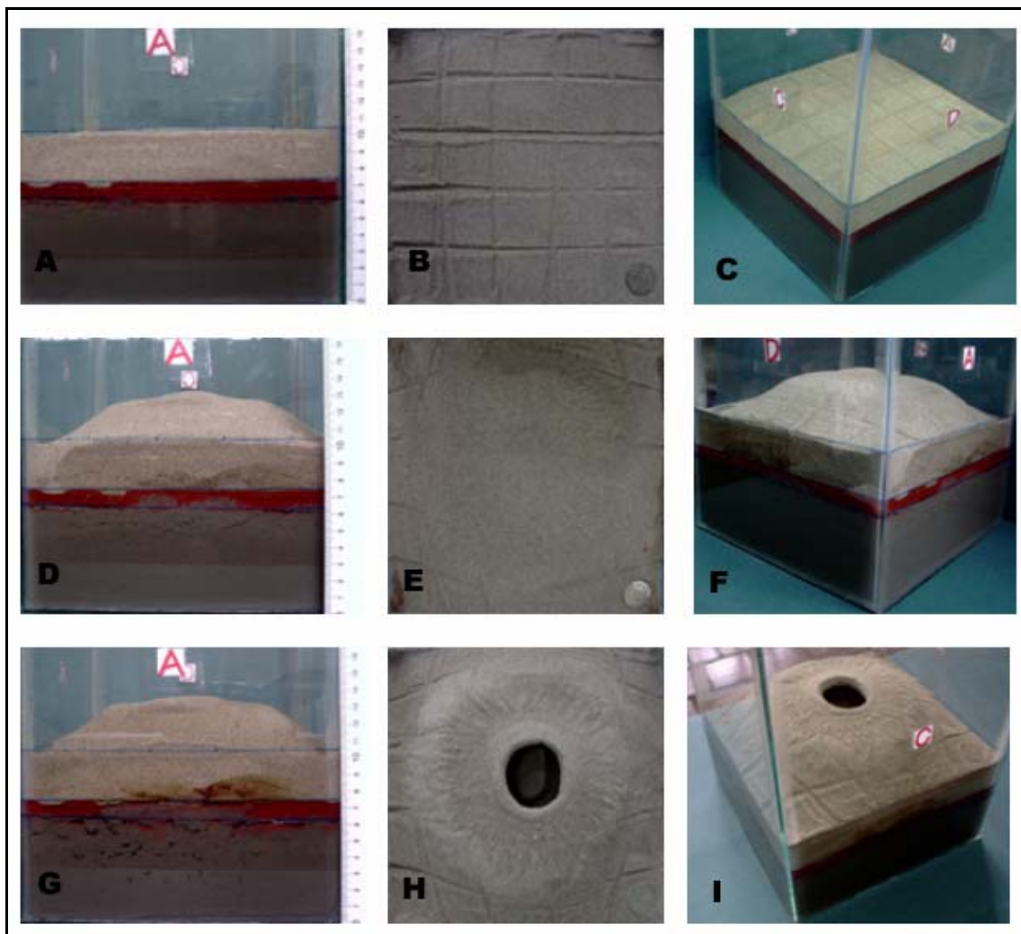
Figura 7. Evolución Experimento G2.1. Lodo con guarapo (7 cm) + capa impermeable (1 cm) + arena (3 cm). Izquierda: vistas frontales en la cara A del montaje. Medio: Vistas en planta (20 cm × 20cm). Derecha: Vistas oblicuas donde se percibe mejor la tridimensionalidad del modelo. A, B, y C: Condiciones iniciales. En B se puede observar la retícula trazada sin mayor deformación. D, E y F. t = 50 Horas: Momento de máxima altura: El domo más amplio tiene 27 mm de alto y 12 mm de diálogo; el domillo central sobre este domo mayor de 5 mm de altura y 4 mm de diálogo. En la vista en planta (E), la retícula se ha borrado y se encuentra muy deformada. En D y F se observa un domillo sobre el domo mayor y la arena ligeramente humedecida. G, H e I; t = 106 horas. Colapso del domillo central dejando aparentemente intacto el domo mayor, pero con un espacio bajo éste donde se encuentra el material que conformaba el domillo central sobre el domo mayor.
