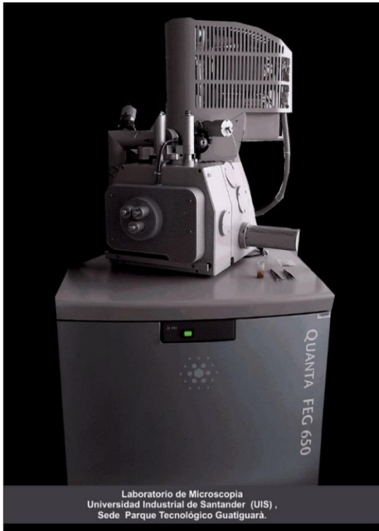
FIGURA 8. Microscopio Electrónico de Barrido Ambiental con Fuente de Emisión de Campo marca FEI, modelo Quanta 650
