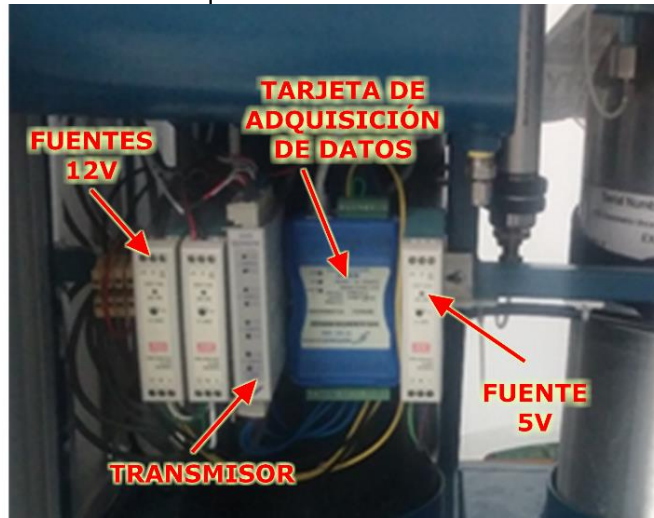
Figura 65 Ubicación del sistema de adquisición de datos
