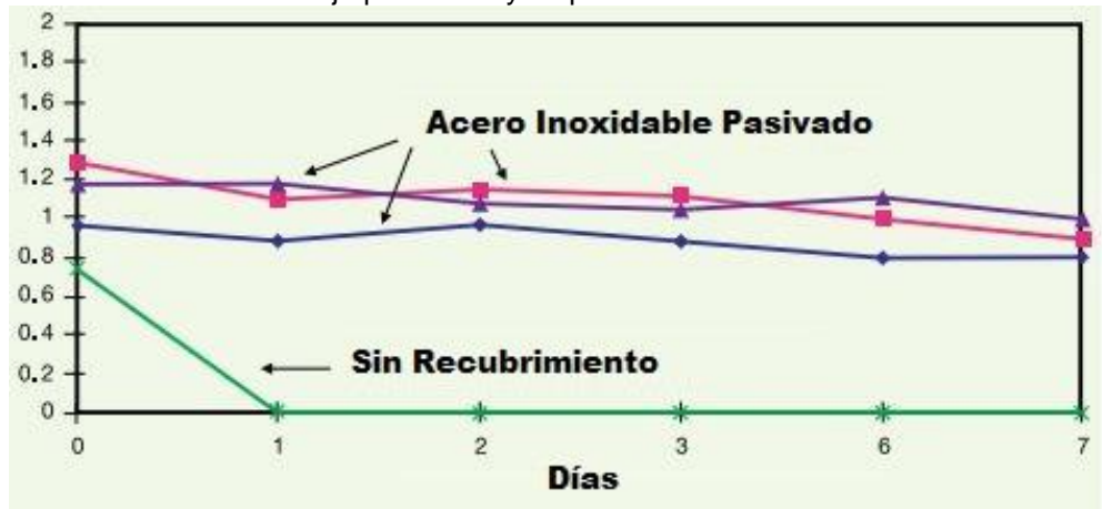
Figura 29. Adsorción en líneas de flujo pasivadas y no pasivadas
