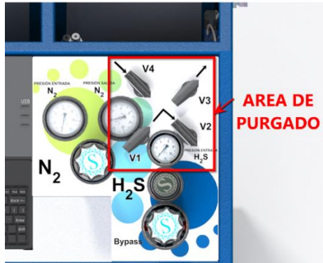
Figura 70. Posición correcta de las válvulas de purgado
