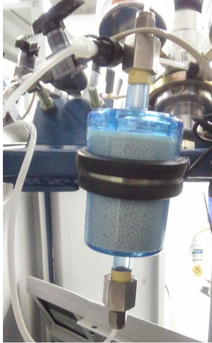
Figura 62. Filtro de adsorción en el equipo
