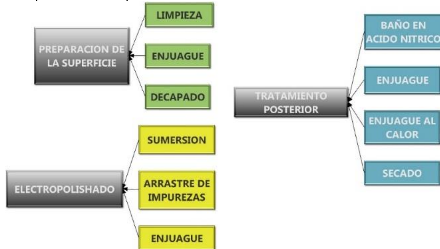
Figura 26. Pasos para un Electropolishado de alta calidad
