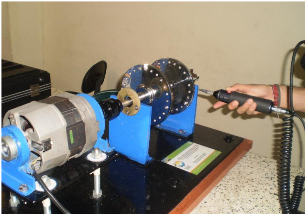
Figura 73. Toma de vibraciones.
