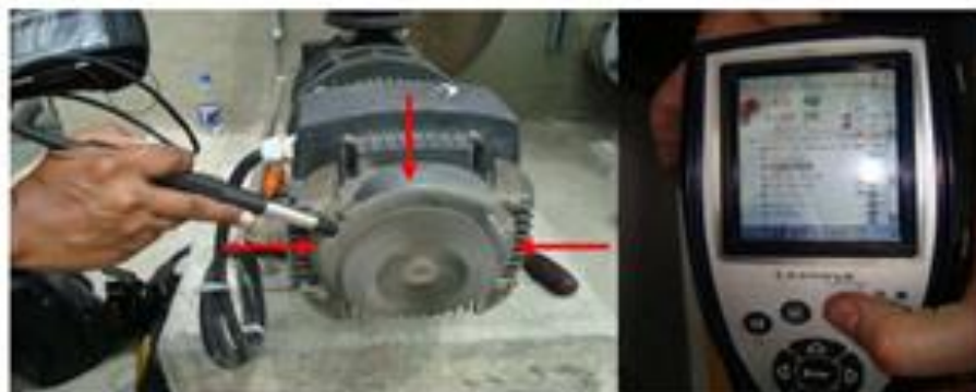
Figura 22. Medición de impulsos de choque
