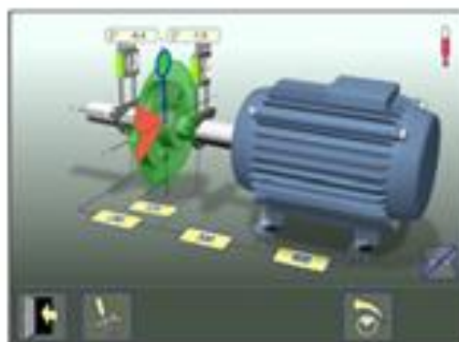
Figura 13. Segunda posición de alineamiento.
