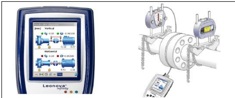
Figura 18. Alineación de ejes.
