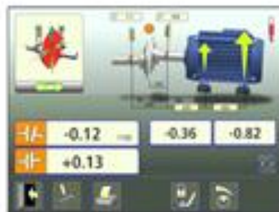
Figura 21. Corrección alineamiento vertical.
