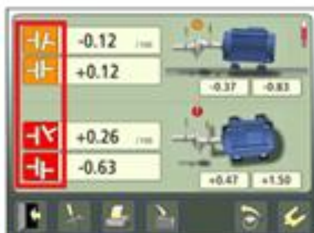
Figura 16. Dirección de desalineamiento.
