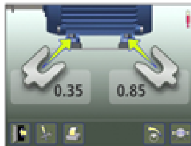
Figura 19. Ajuste con suplementos.
