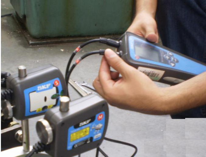
Figura 54. Conexión de sensores.
