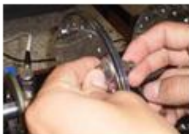
Figura 8. Postura de masa de desbalance.
