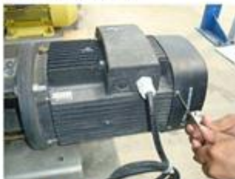
Figura 21. Tapa de seguridad
