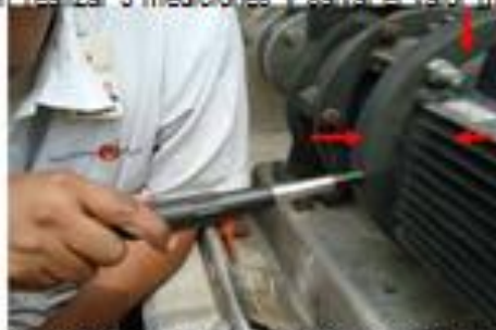
Figura 32. Medición de impulsos de choque en acople
