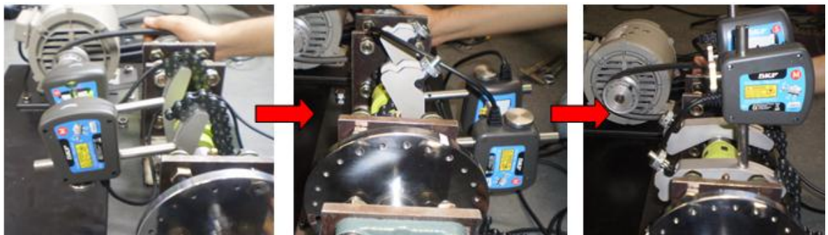
Figura 57. Toma de datos con alineador.
