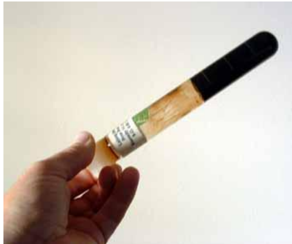
Figura 3. Prueba del Punto de Fluidez a una muestra de aceite.
