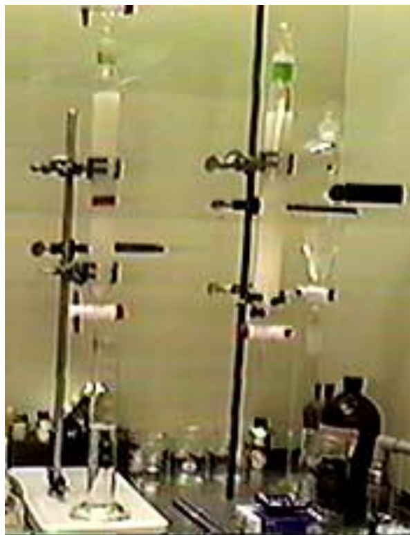
Foto 7. Columna Cromatográfica para la Separación de Maltenos.
