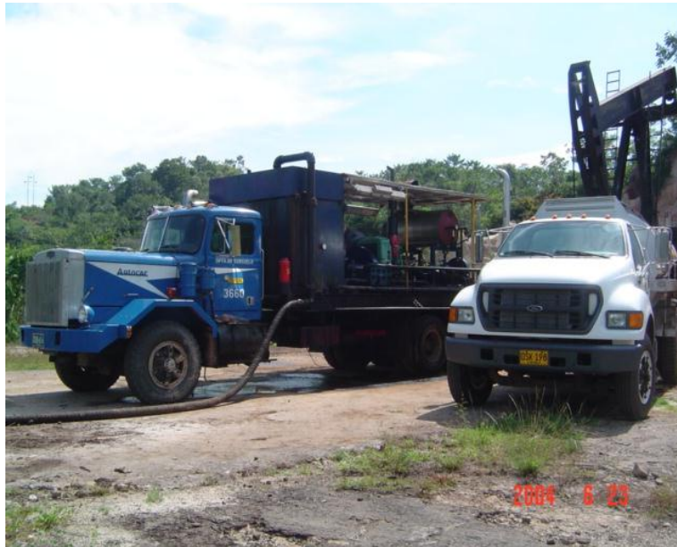
Figura 6. Proceso de Inyección Aceite Caliente – Lisama
