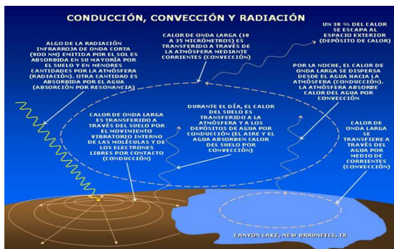
Figura 4. Conducción, convección y radiación
