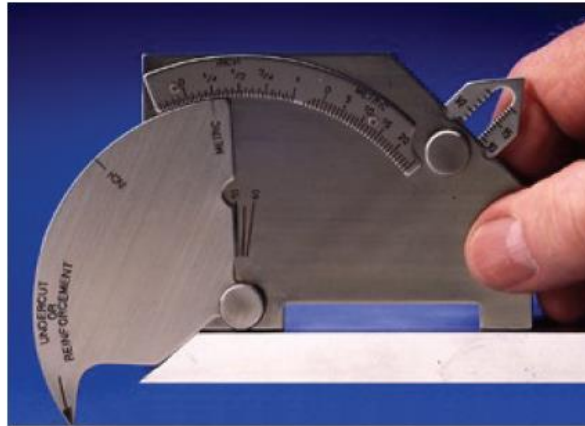
Imagen 10. Galga pico de Loro para inspección de soldadura.
