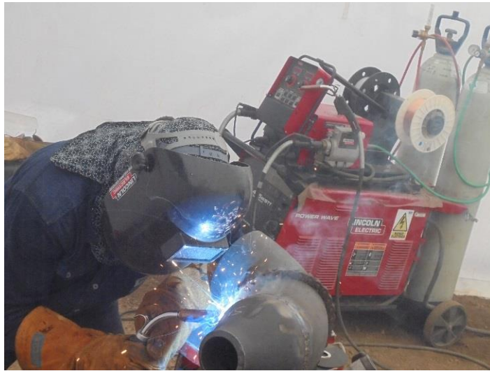
Imagen 3. Proceso GMAW. Gas Metal Arc Welding.
