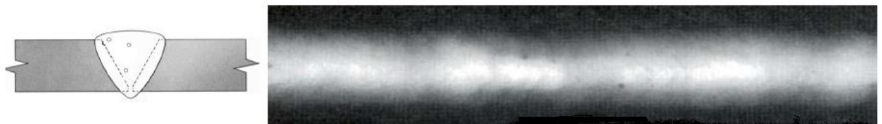
Imagen 5. Radiografía con Porosidad Aislada (PA).
