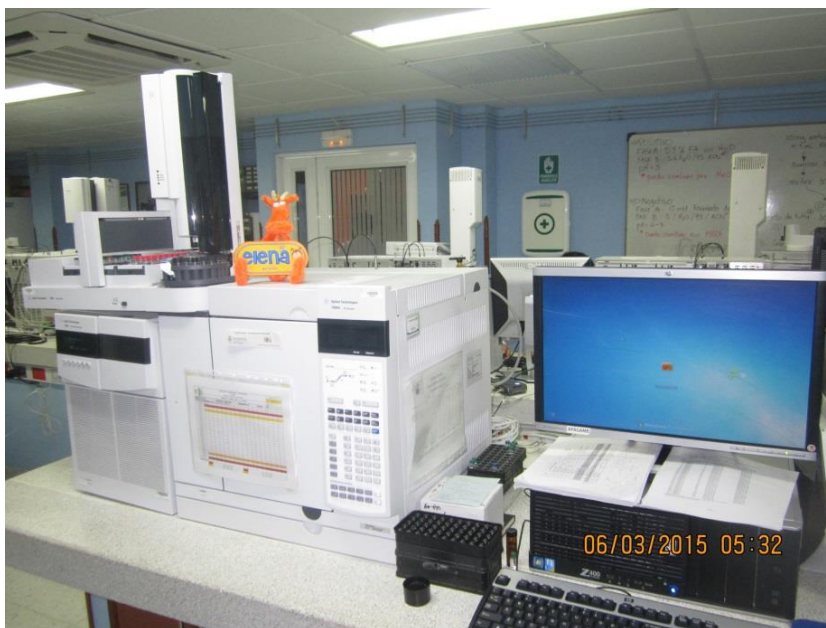
Figura 23. Cromatógrafo AT 7890N acoplado a un detector de masas triple cuadrupolo (QqQ) AT 7000.
