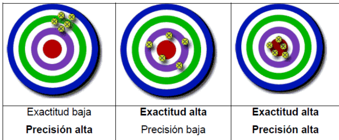
Figura 2. Representación concepto exactitud y precisión
