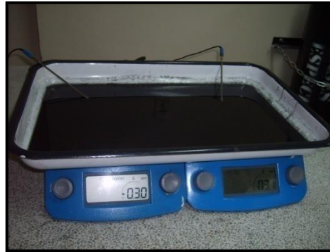
Figura 18. Secado de los polvos de la aleación de titanio.
