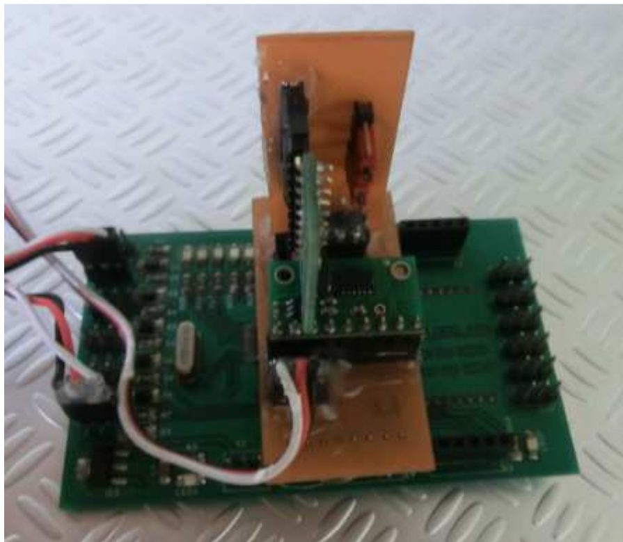
Figura A.3.4: Tarjeta construida para lectura y transmisión inalámbrica de datos sensados.
