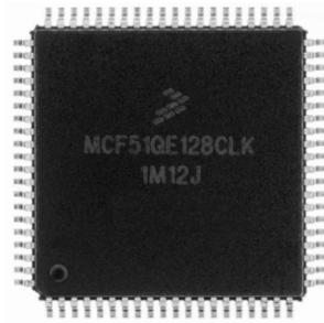
Figura A.3.1: Microcontrolador MCF51QE128 de Freescale.
