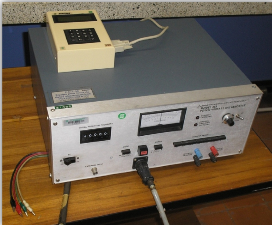
Figura 23. Potencióstato-Galvanostato Princeton modelo 363 y sistema de adquisición de datos SCAP363.
