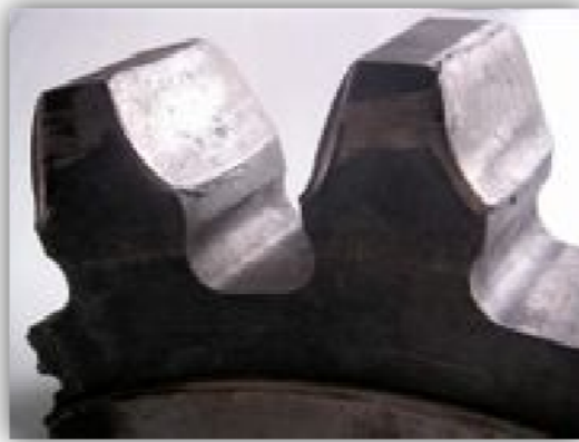
Figura 4. Desgaste en los dientes de un engranaje debido a la fricción.
