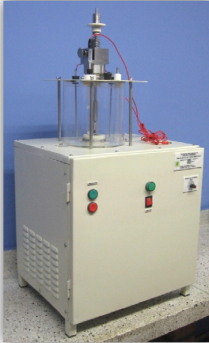
Figura 91. Montaje final del tribómetro.
