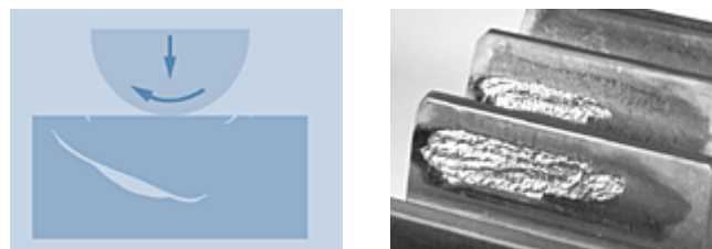
Figura 8. Ejemplo de desgaste por Fatiga Superficial.
