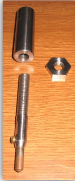
Figura 87. Acoplamiento del indentador tipo inserto a la puntera 2.
