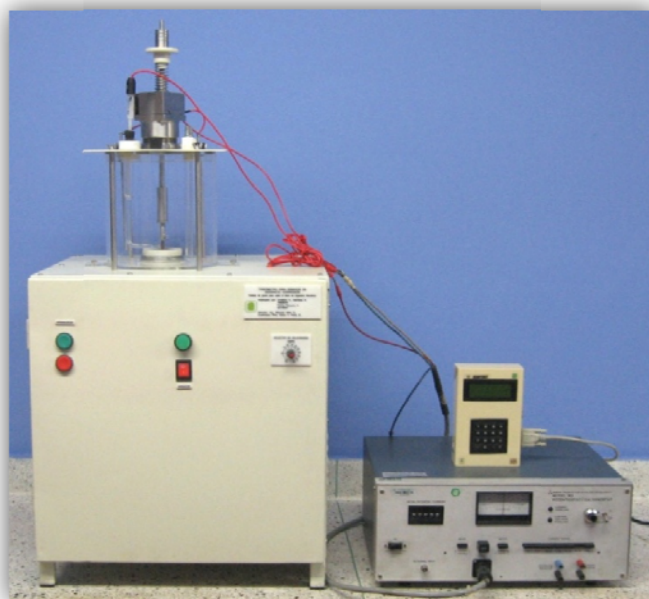
Figura 94. Conexión entre el Tribómetro, potencióstato y Scap363.
