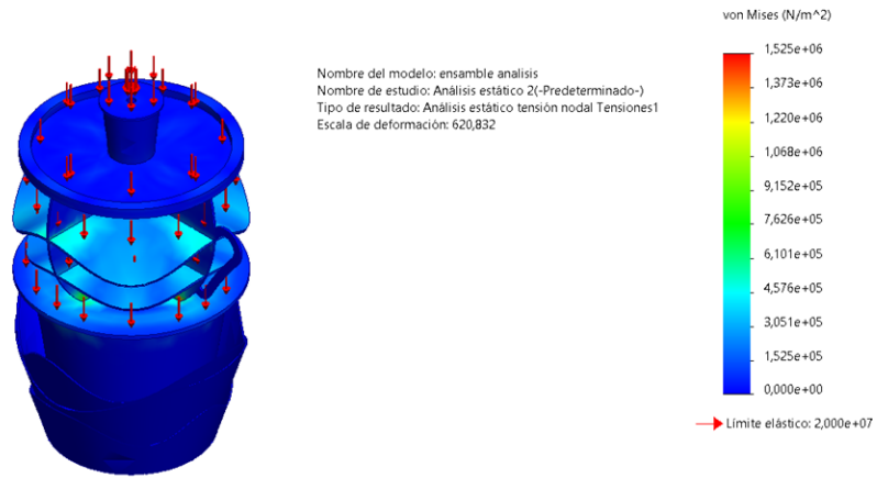
Tensiones evidenciadas en la simulación de la Alternativa 3.
