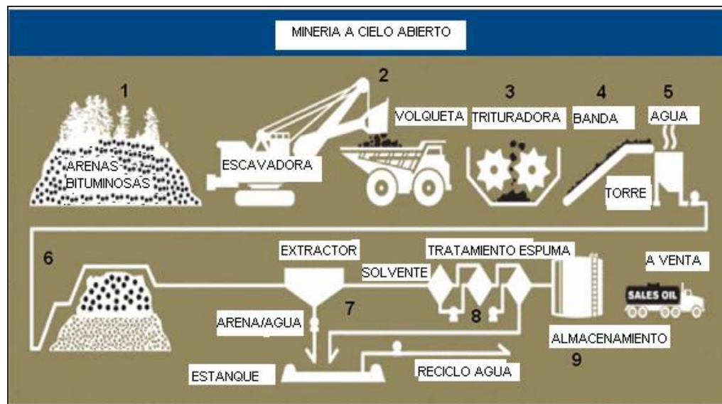
Figura 28. Proceso de extracción de las Arenas Bituminosas en mina a cielo abierto.
