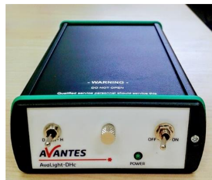
Figura A2. Fuente de luz AvaLight-DHc
