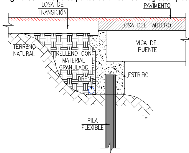
Figura 56. Principales partes de un estribo integrado típico.
