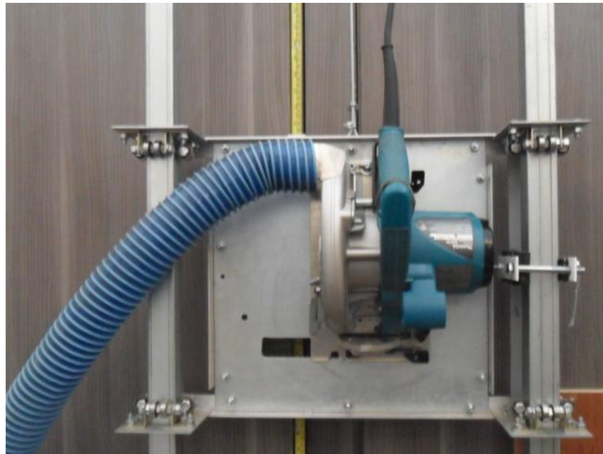
Figura 76. Instalación manguera de aspiración.
