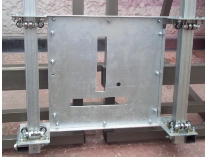
Figura 69. Proceso de ensamble sistema de rodamientos.
