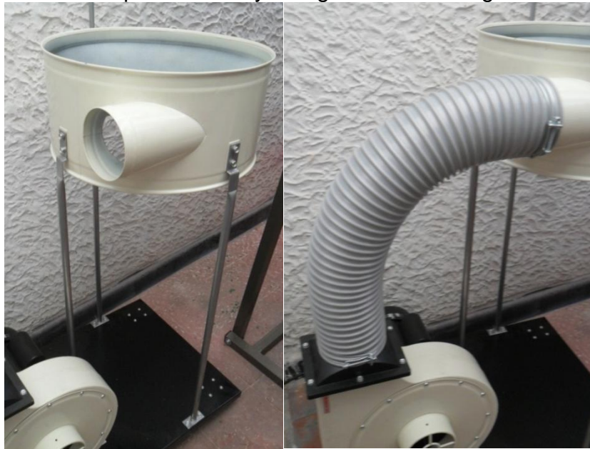
Figura 74. Ensamble soportes bolsa y manguera de descarga.
