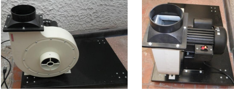
Figura 73. Proceso de instalación del ventilador centrífugo.
