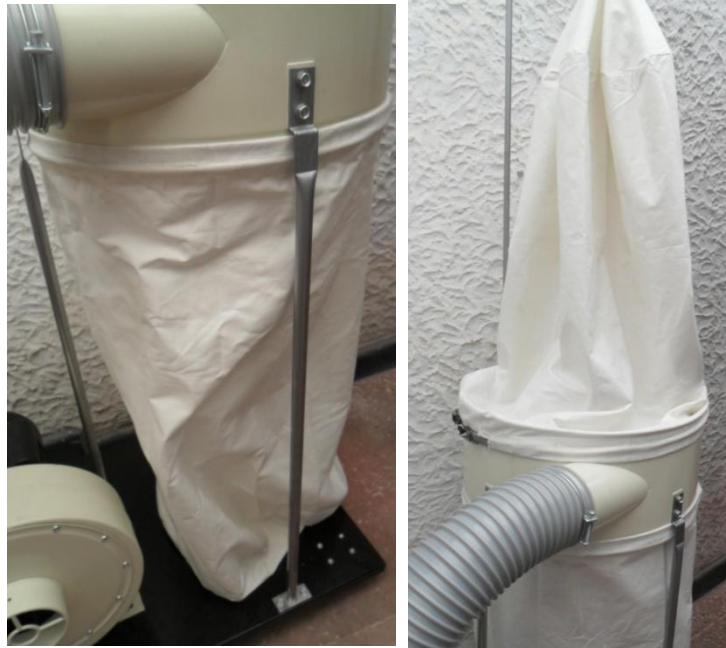
Figura 75. Instalación bolsa de recolección.
