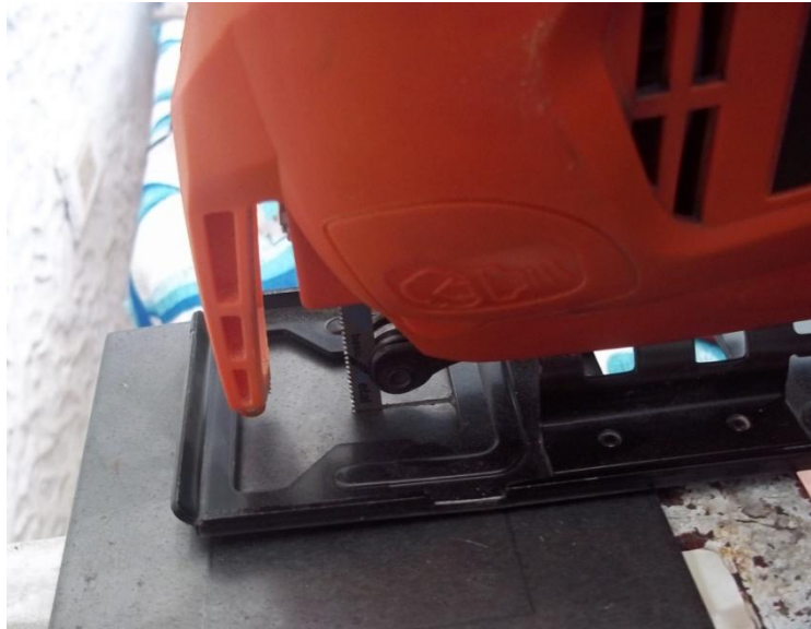
Figura 66. Corte de lámina mediante Sierra Caladora.
