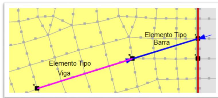
Figura 23. Muestra grafica de los elementos tipo barra y tipo viga. Adaptado de: Sigma W
