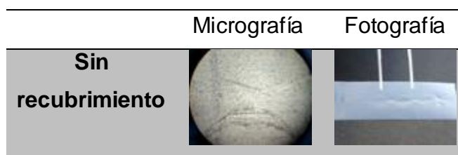
Figura 12. Resultado del Scotch Test sobre la malla sin recubrimiento.
