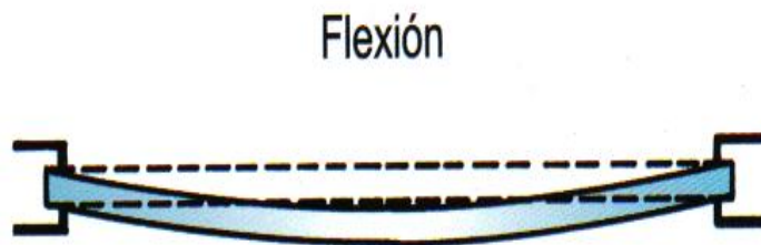
Figura 11. Vidrio sometido a flexión.
