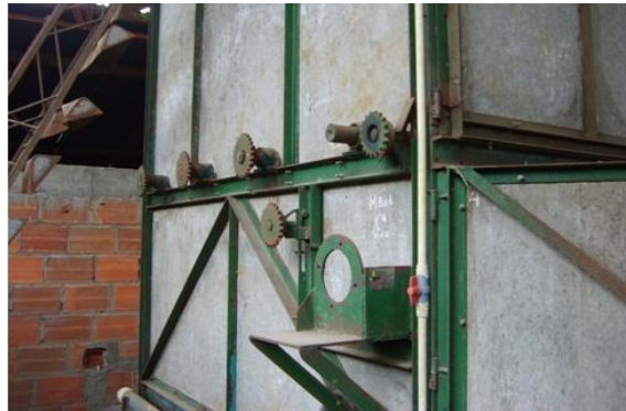
Foto13. Sistema de transmisión. Sin cadena y sin motor. Fuente: el Autor.
