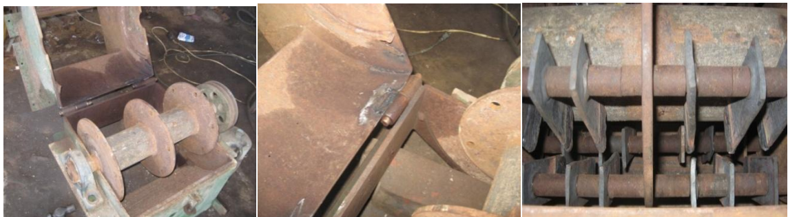
Foto 1. Muestra del proceso de mantenimiento del molino de martillos. Fuente: el Autor.
