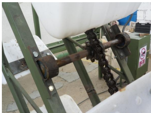
Foto 3. Guías para la cadena en la estructura de transporte por cangilones. Fuente: el Autor
