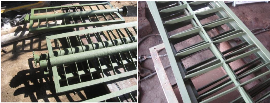
Foto 5. Paletas y Bandejas del Bio-reactor respectivamente, con capa de pintura anticorrosiva. Fuente: el Autor
