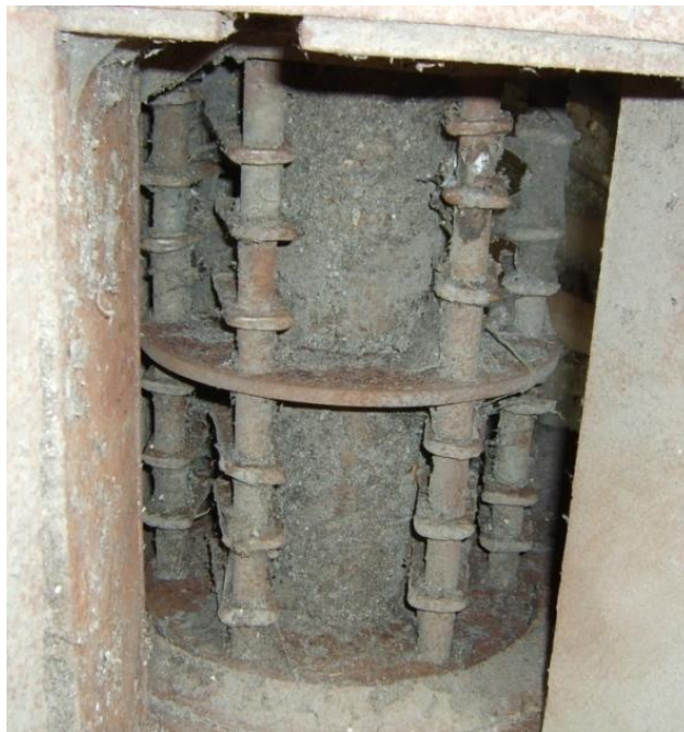
Foto 10. Martillos de la trituradora. Estado inicial. Fuente: el Autor
