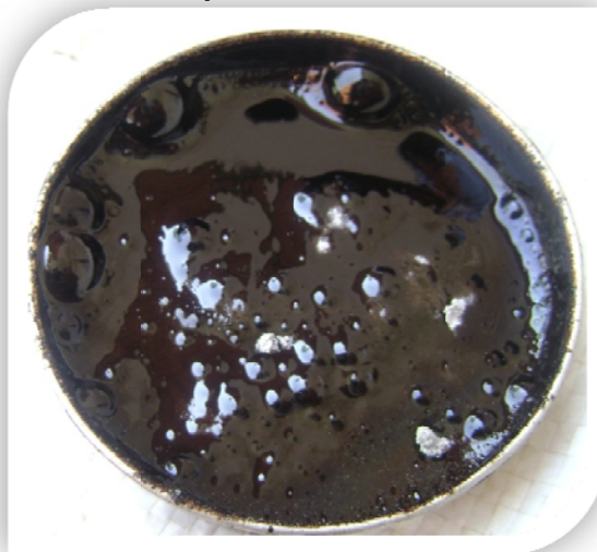
Espumado del asfalto
