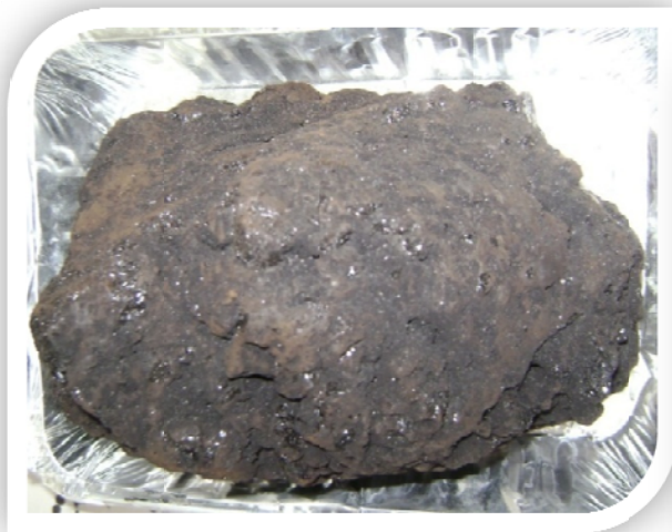
Fotografía 2.1. Asfaltita sin pulverizar
