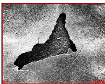
Figura 11. Micrografía de SEM-EDS para el cupón expuesto a Dimetil Disulfuro (DMDS) a 300 °C y 72 horas.
