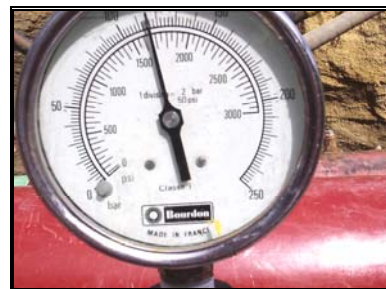
Fotos 1.19 a 1.21. Prueba hidrostática.
