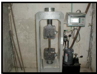
Figura 53 Ensayo de resistencia a la tracción de probetas de acero
