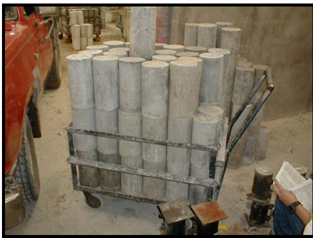
Figura 24. Cilindros de concreto para ensayo de compresión
