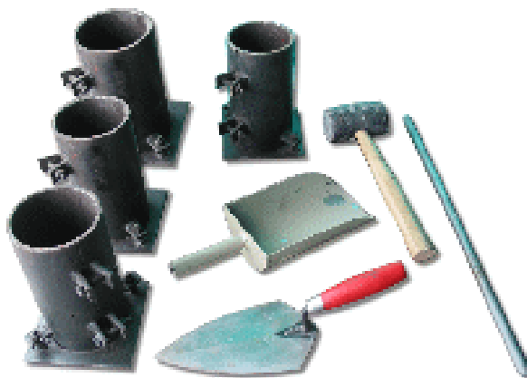
Figura 34. Equipo Para elaboración de cilindros de concreto
