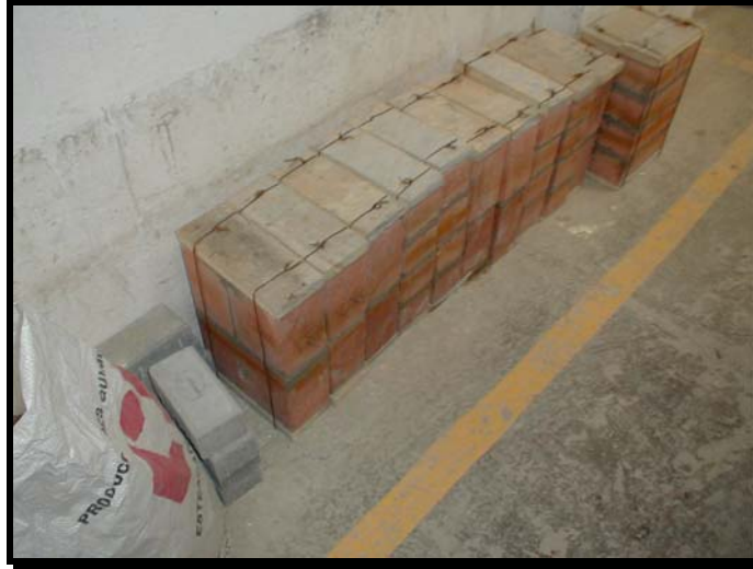
Figura. 63 Muretes listos para ser transportados de la obra al laboratorio
