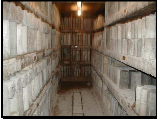
Figura 26. Cuarto de curado para elementos de concreto
