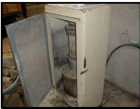
Figura 30. Ensayo de compresión para cilindros de mortero
