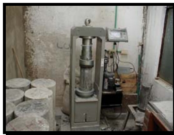
Figura 20. Ensayo a compresión de cilindros de concreto
