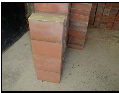
Figura 62 Muretes listos para ensayo de compresión
