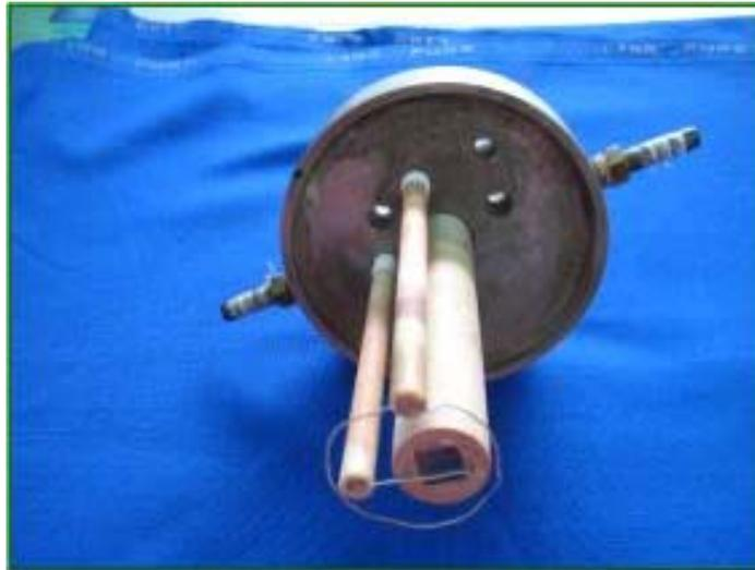
**Fotografía 1. Arreglo de los electrodos de la celda electroquímica**
