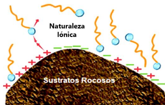
Figura 14. Adsorción del surfactante en el sustrato rocoso
