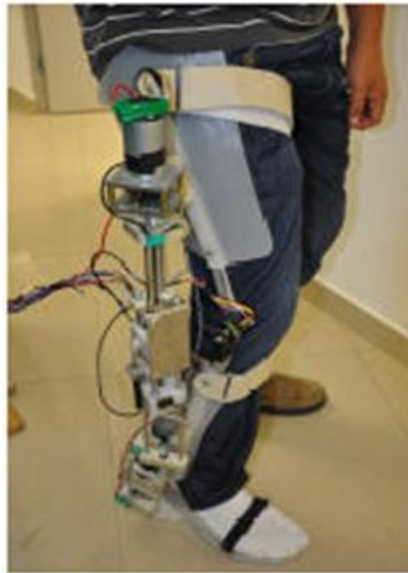
Figura 24. Modelo mecánico del actuador para Rodilla y Tobillo
