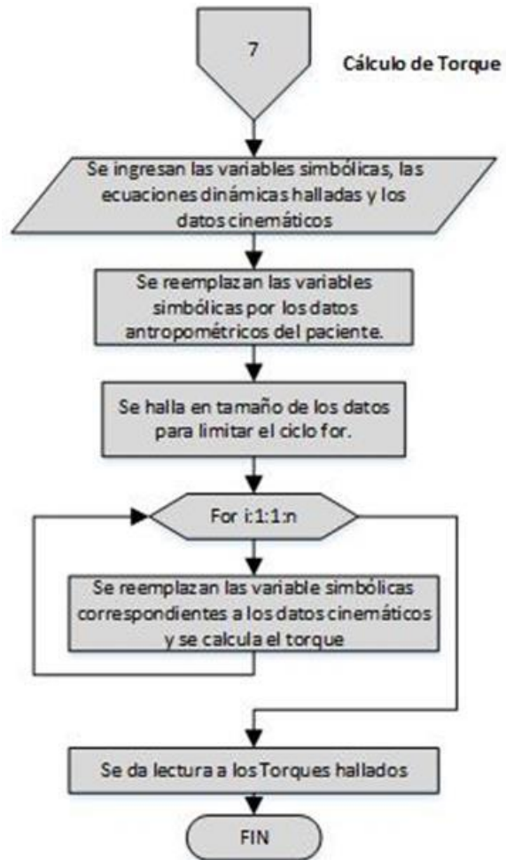
Figura 51. Diagrama de flujo para el cálculo de Torque
