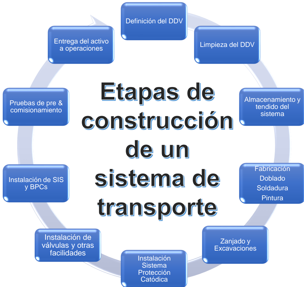
Figura 10. Etapas de construcción de un sistema de transporte
