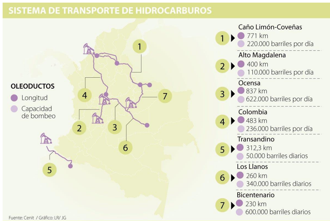
Figura 5. Sistema de Transporte de Hidrocarburos
