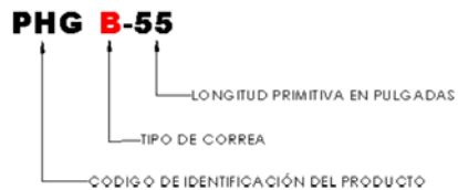
Figura 2. Designación de las correas clásicas de uso industrial según la SKF
