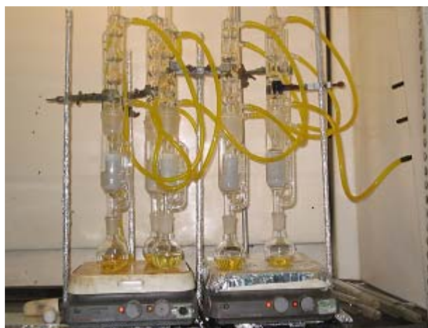
Figura 5. Montaje del equipo de la extracción soxhlet.
