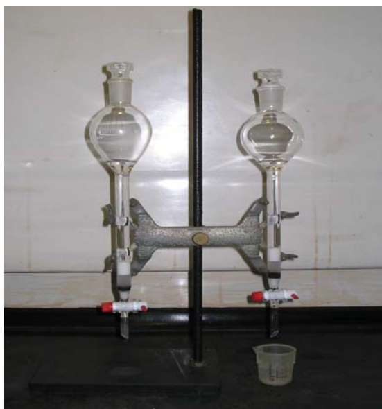
Figura 6. Montaje del empacado de la columna abierta.
