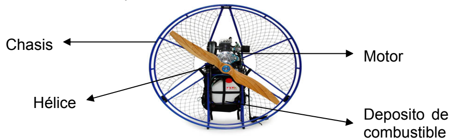
Figura 72. Partes de un paramotor
