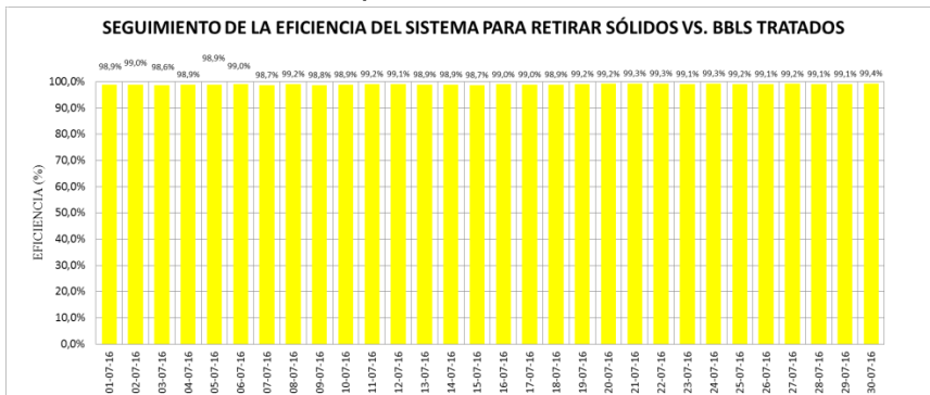
Figura 29. Eficiencia del sistema para retirar SST
