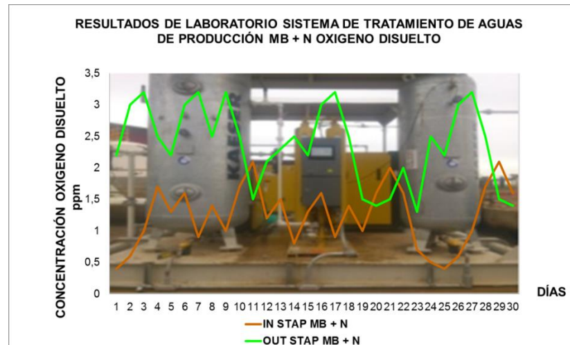
Figura 34. Resultados laboratorio OXIGENO DISUELTO MB NITROGENO
