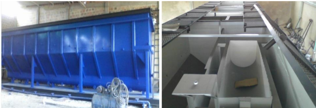
Figura 16. Unidad de tratamiento de agua con microfiltración
