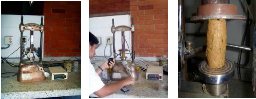
Figura 13. Equipo y proceso utilizado en el ensayo de Compresión simple
