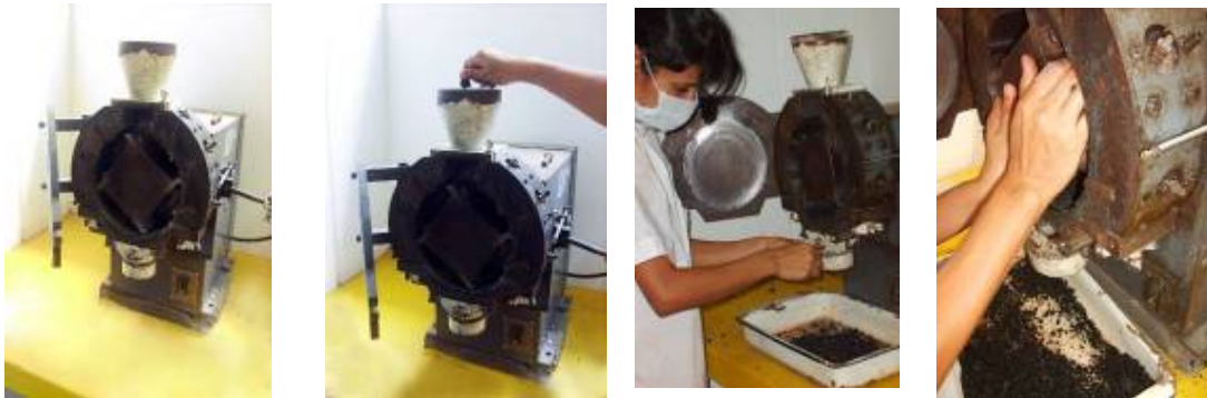
Figura 5. Equipo utilizado para la trituración de neumático
