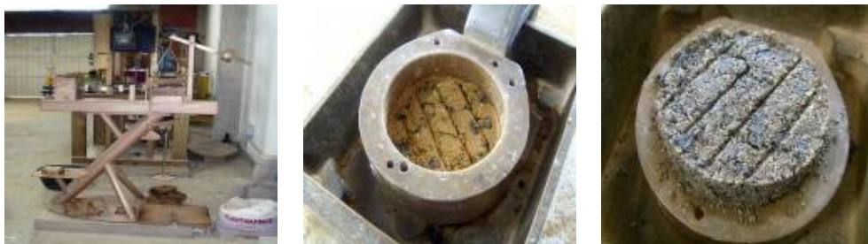
Figura 14. Equipo y proceso utilizado en el ensayo de Corte Directo
