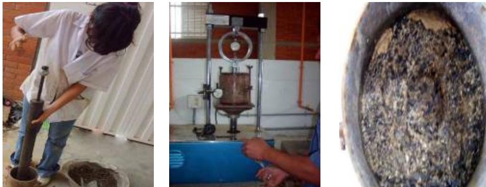
Figura 15. Equipo y Proceso utilizado en el ensayo de CBR
