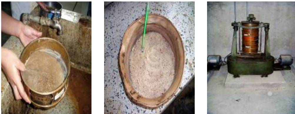
Figura 7. Equipo y proceso utilizado en el ensayo de granulometría
