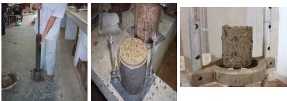
Figura 12. Equipo y proceso utilizado en el ensayo de Proctor Modificado
