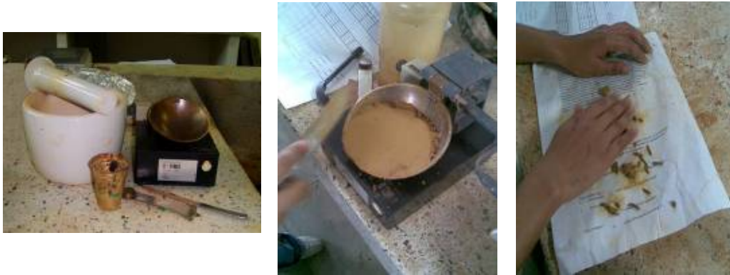
Figura 8. Equipo y proceso utilizado en el ensayo de Límites de Atterberg
