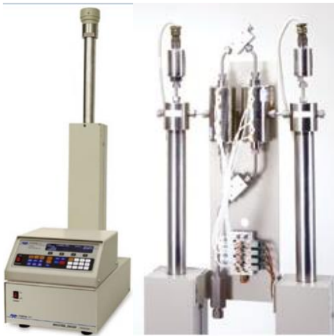
Figura 8. Bomba de Teledyne ISCO modelo 260 D con Accesorios
