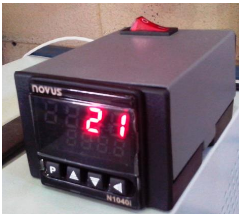
Figura 6. Indicador Universal marca NOVUS modelo N1040i
