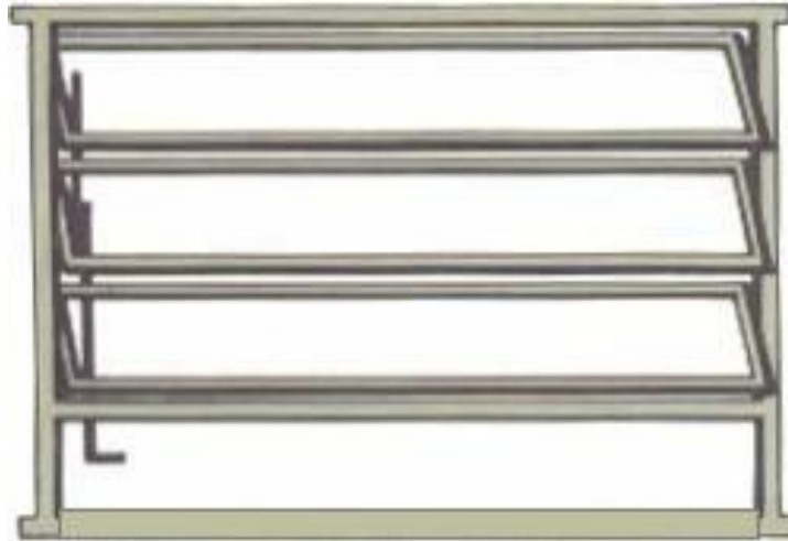
Imagen5. Ventana de Celosía
