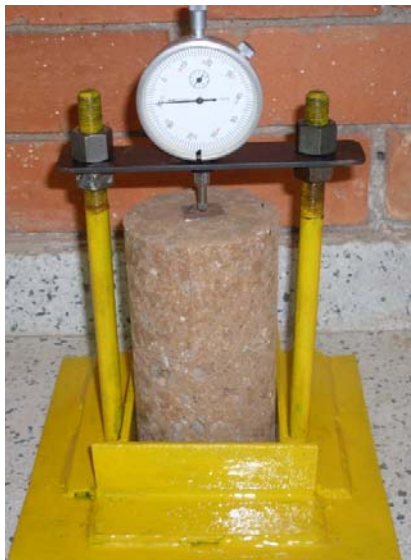
Figura 9. Montaje para medir las retracciones de las probetas.
