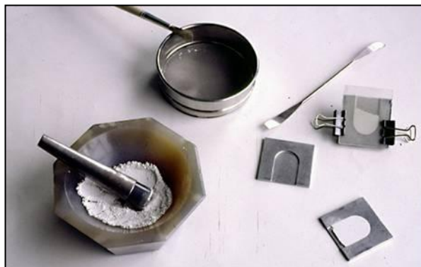
Figura 8. Montaje de muestra por técnica de llenado lateral
