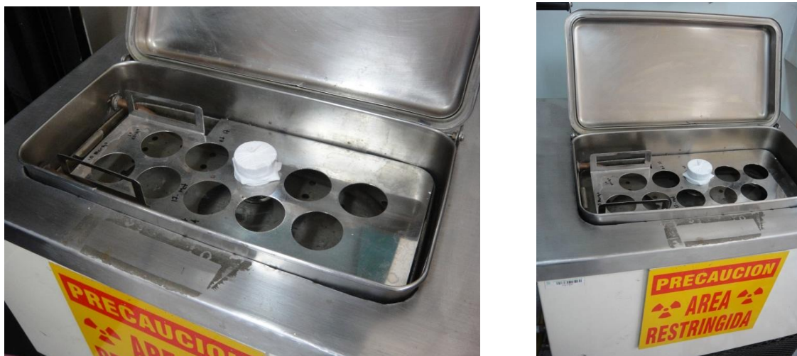
Figura 11. Equipo térmico para las cristalizaciones de las 4-tiazolidinonas bajo condiciones cinéticas y termodinámicas
