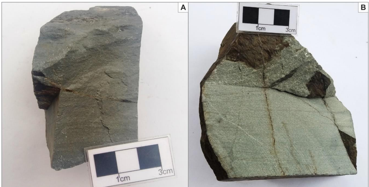
Figura 21. Características macroscópicas de las filitas moscovíticas – cuarzosas con clorita. A: muestras SB-179; B: muestra SB-186.
