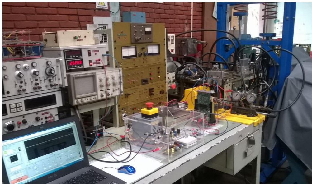
Figura 41. Vista del montaje para el control de posición por medio de válvula proporcional.
