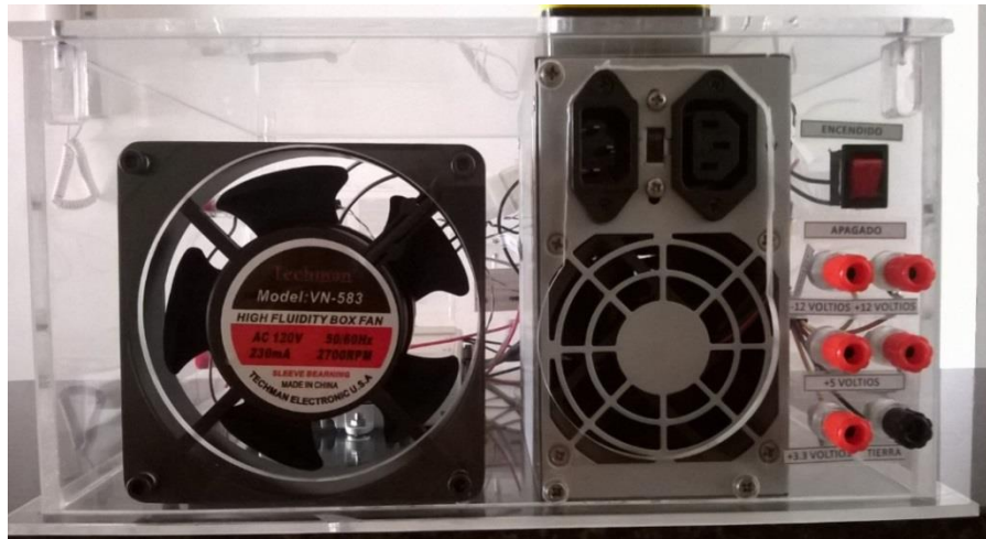
Figura 115. Módulo AAA (Alimentación, Amplificación y Almacenamiento).
