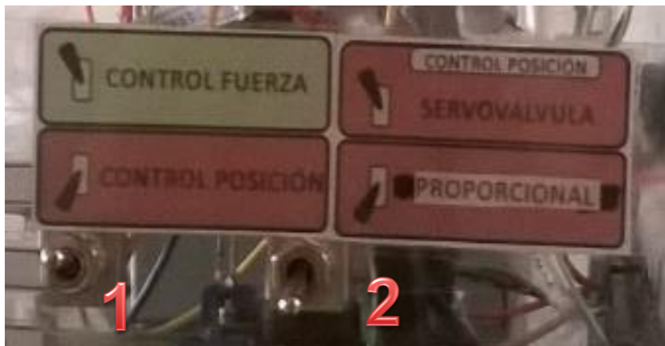
Figura 35. Selectores de las tarjetas de potencia.
