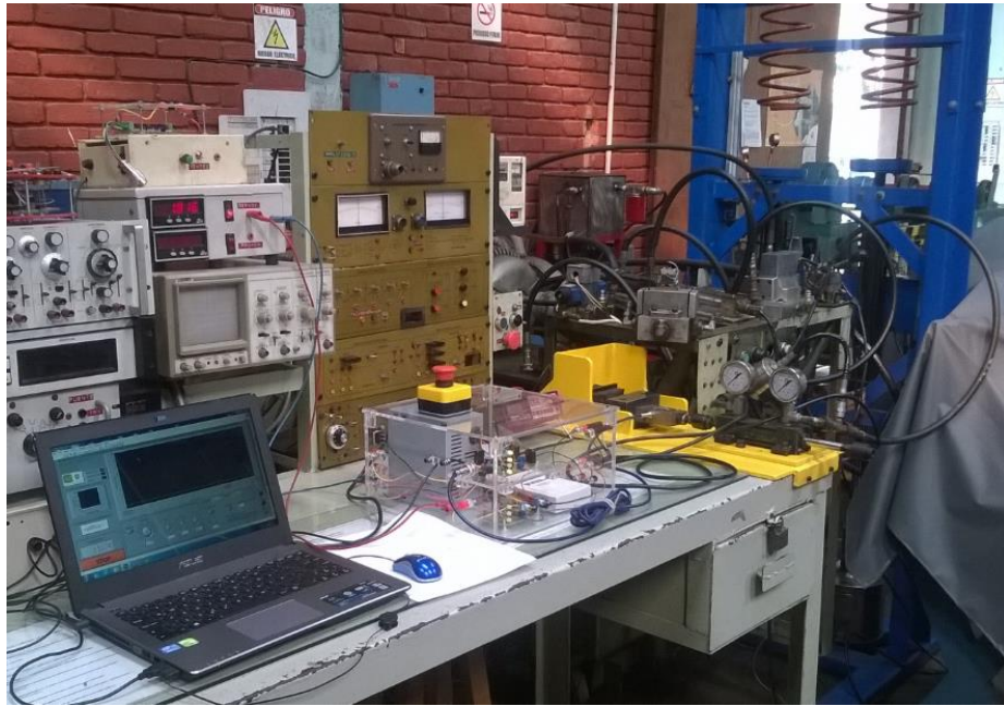
Figura 41. Vista del montaje para el control de posición por medio de válvula proporcional.
