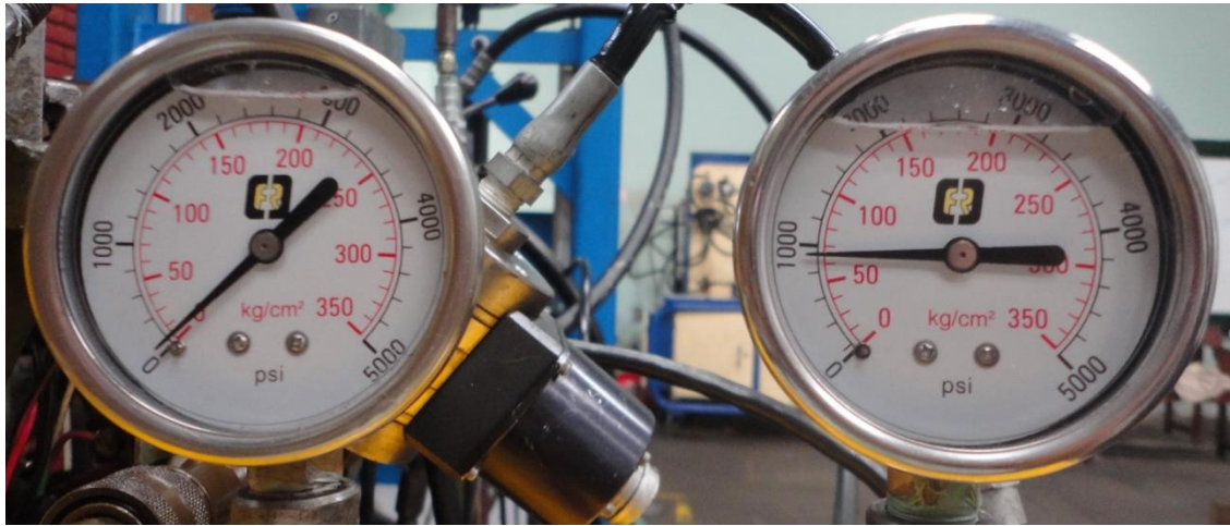
Figura 102. Visualización del diferencial de presión a través de los manómetros.
