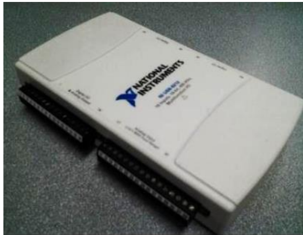
Figura 44. Tarjeta de adquisición de datos NI DAQ USB 6212.
