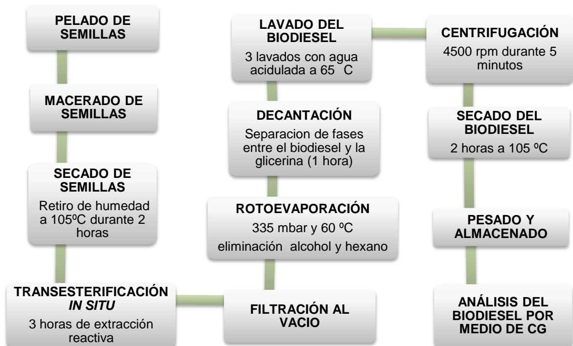
Figura 4. Secuencia experimental en la transesterificación in-situ
