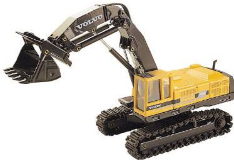
Figura 8. Pala excavadora frontal
