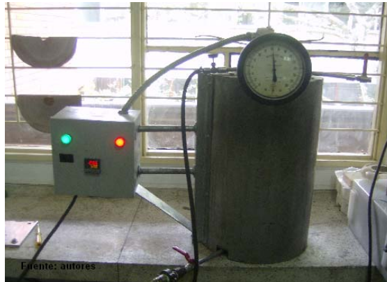
Figura 14. Horno cilíndrico vertical utilizado en el proceso de nitruración.
