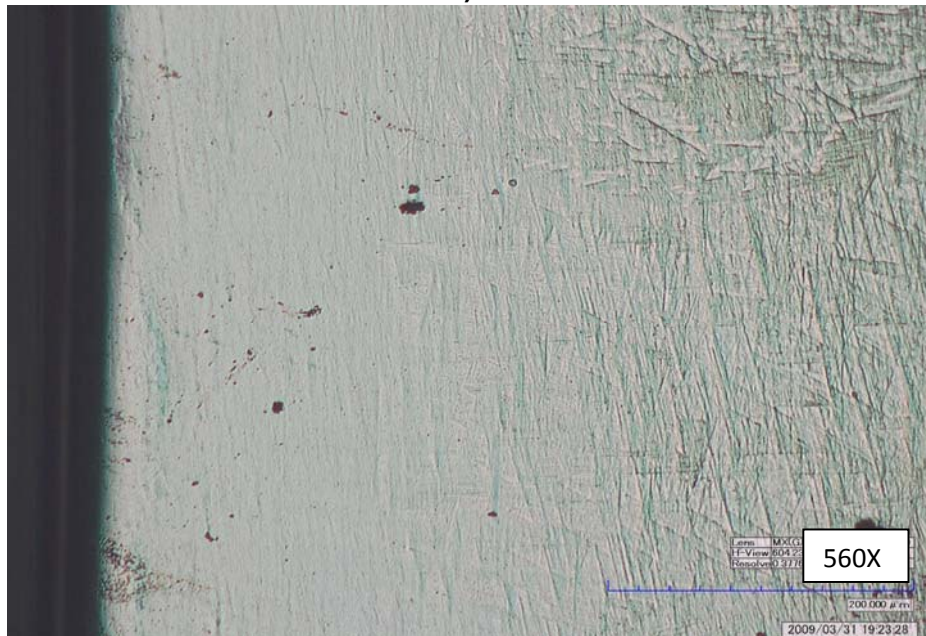
Figura 44. Nitruración 750_4; a) zona superficial con 560x; b) Borde a 560X; atacadas con kroll's durante 15 s, a 560X.
