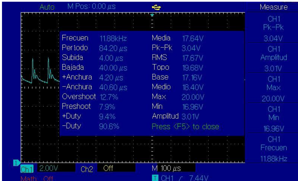
Figura15. Parámetros de operación de la celda generadora de ozono.
