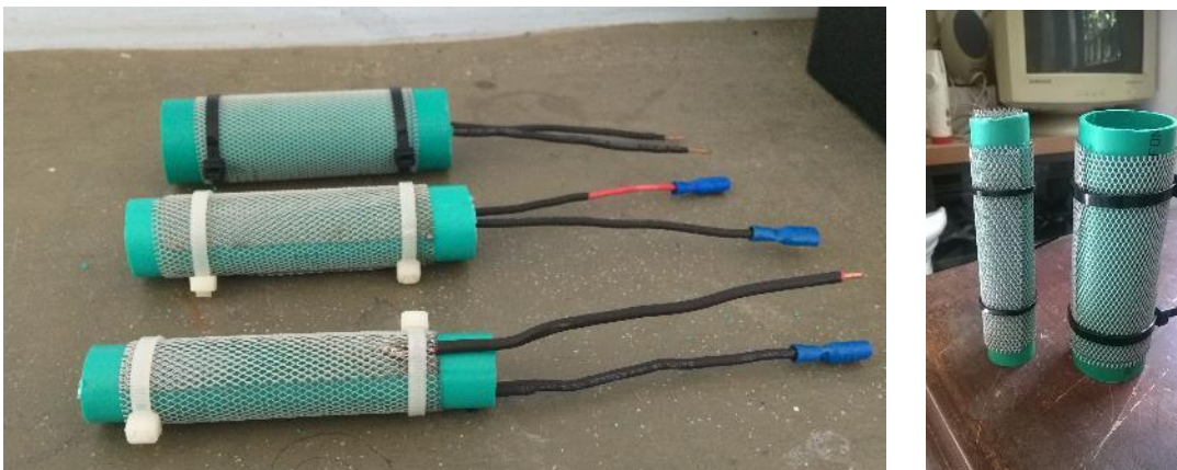
Figura 7. Celdas Generadoras de Ozono.
