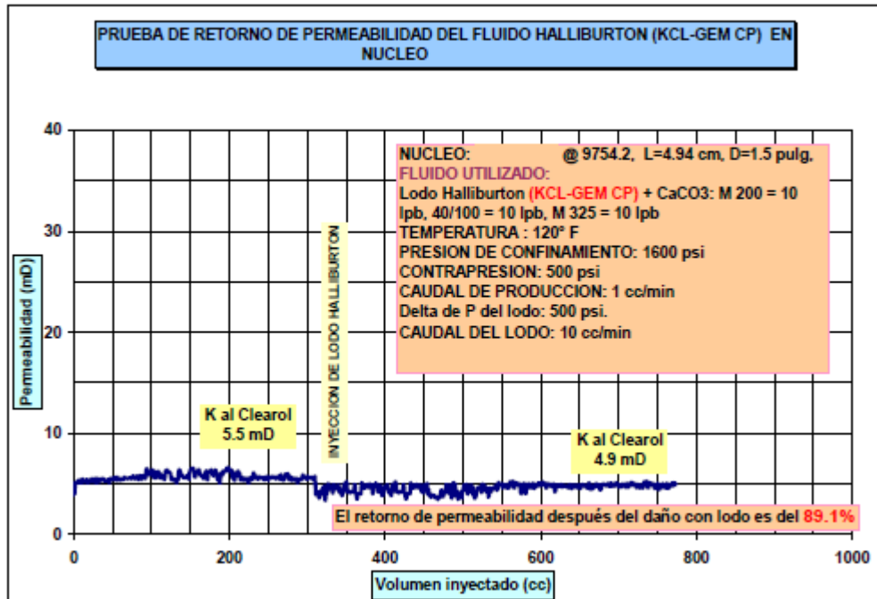
Figura 16. Prueba de retorno de permeabilidad usando el lodo kcl/polímero
