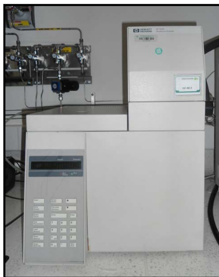
Figura 21. Equipo empleado en la técnica headspace estático. Fotografía tomada por la autora. Lugar: Laboratorio J.J. Thomson, CENIVAM, UIS. Fecha: Mayo de 2013.
