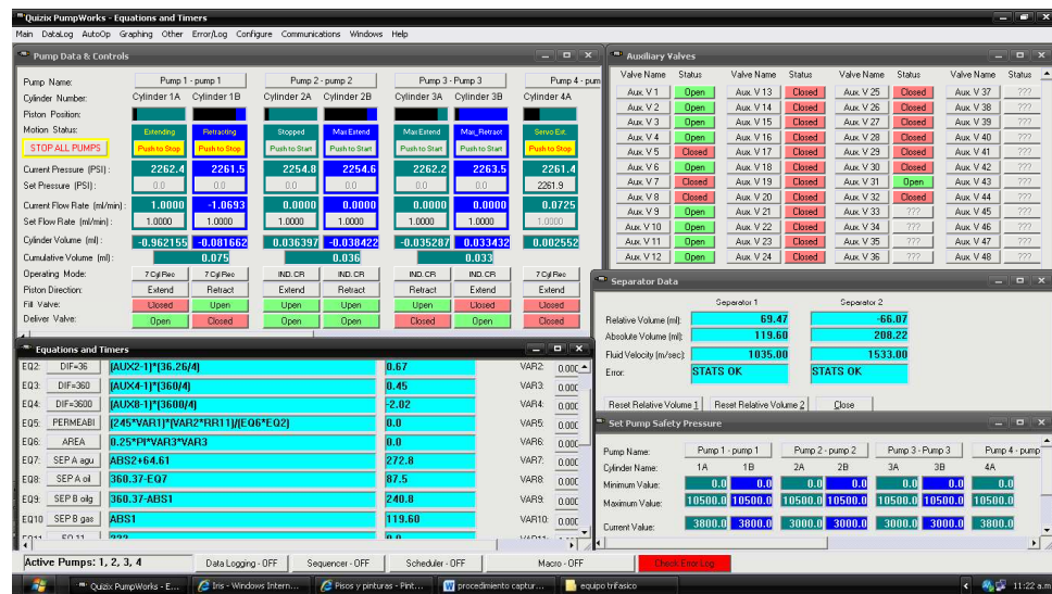
Figura 31. Apertura de válvulas, diferenciales de presión y separador trifásico.
