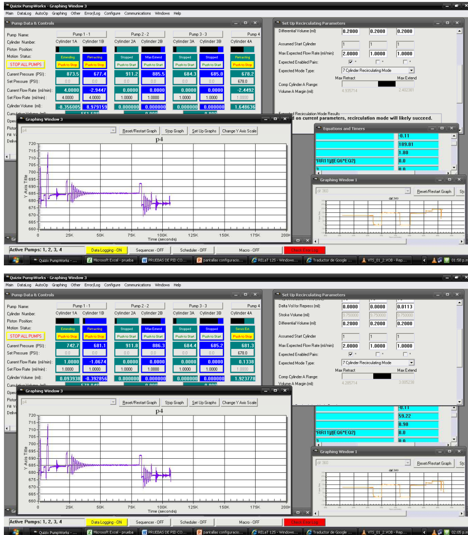
Figura 44. Apagado Bomba y encendido @ caudal 4.0 cc/min.
